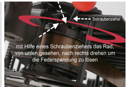
Bild: Federspannung lösen
